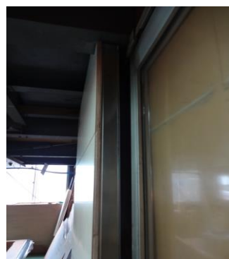
試験体側面 LGS+12 mm合板 +抗菌パネル 5.5 mm
